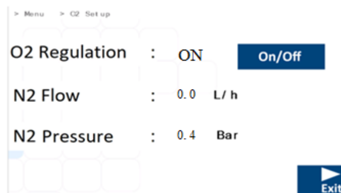
Figuur 16.4 Beeld N 2 -instellingensubmenu in de MIRI® TL6 en MIRI® TL12 IVF incubator met meerdere kamers
