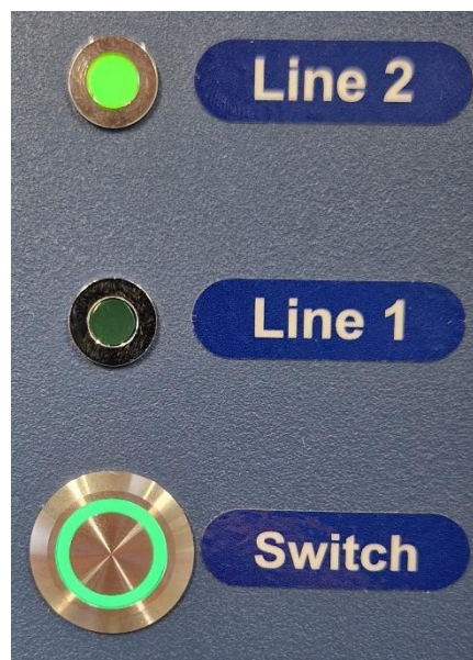
Figuur 20.4 De lijnomschakelaar van de MIRI® TL12 IVF incubator met meerdere kamers en een actieve Lijn 1
