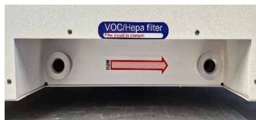
Figuur 12.1 De stroompijl op de MIRI® TL6 en MIRI® TL12 IVF incubatoren met meerdere kamers
